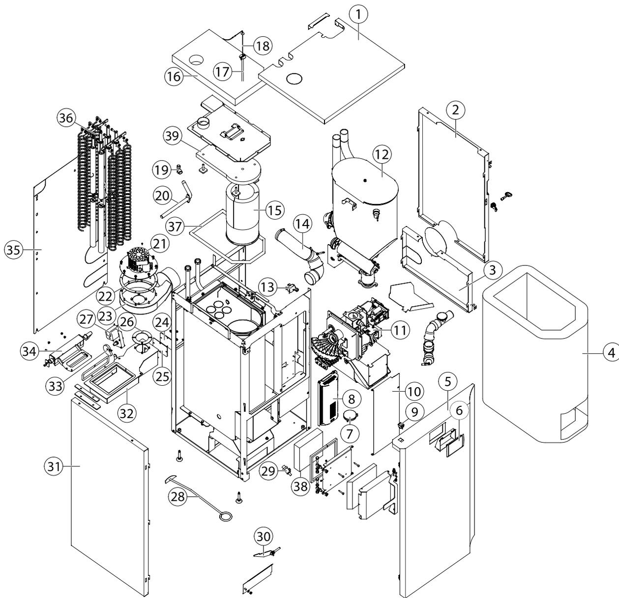
**Caldia a pellet PELEO OPTIMA - Caldaia e rivestimenti**
